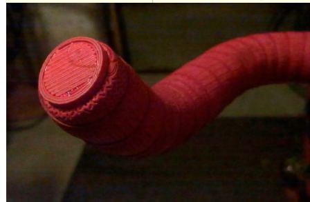
Ohjaustangon tulppa 3d-mallina ja tulostettuna lopullisessa kohteessaan.
